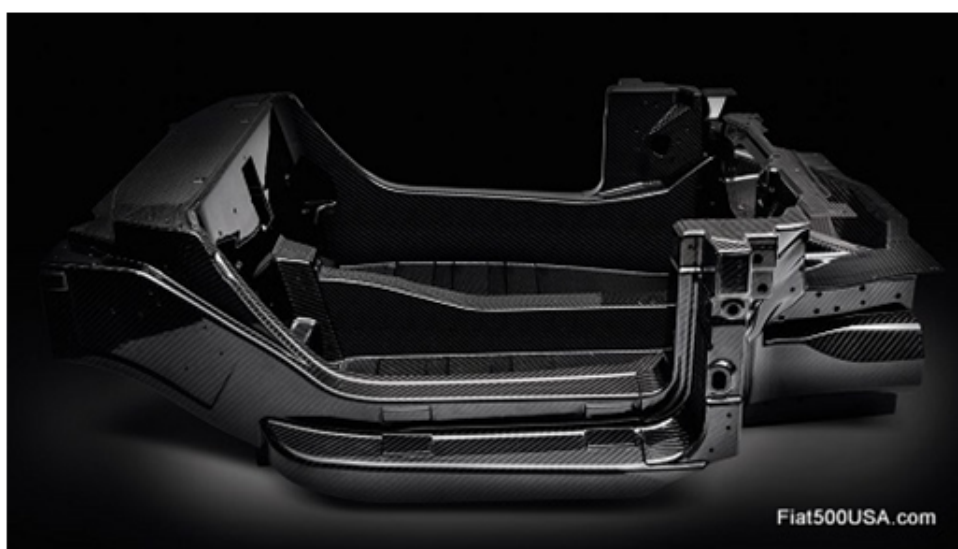
Figura 1.3.4 – Estrutura Monocoque do Alfa Romeo 4C. Adaptado de (4)
