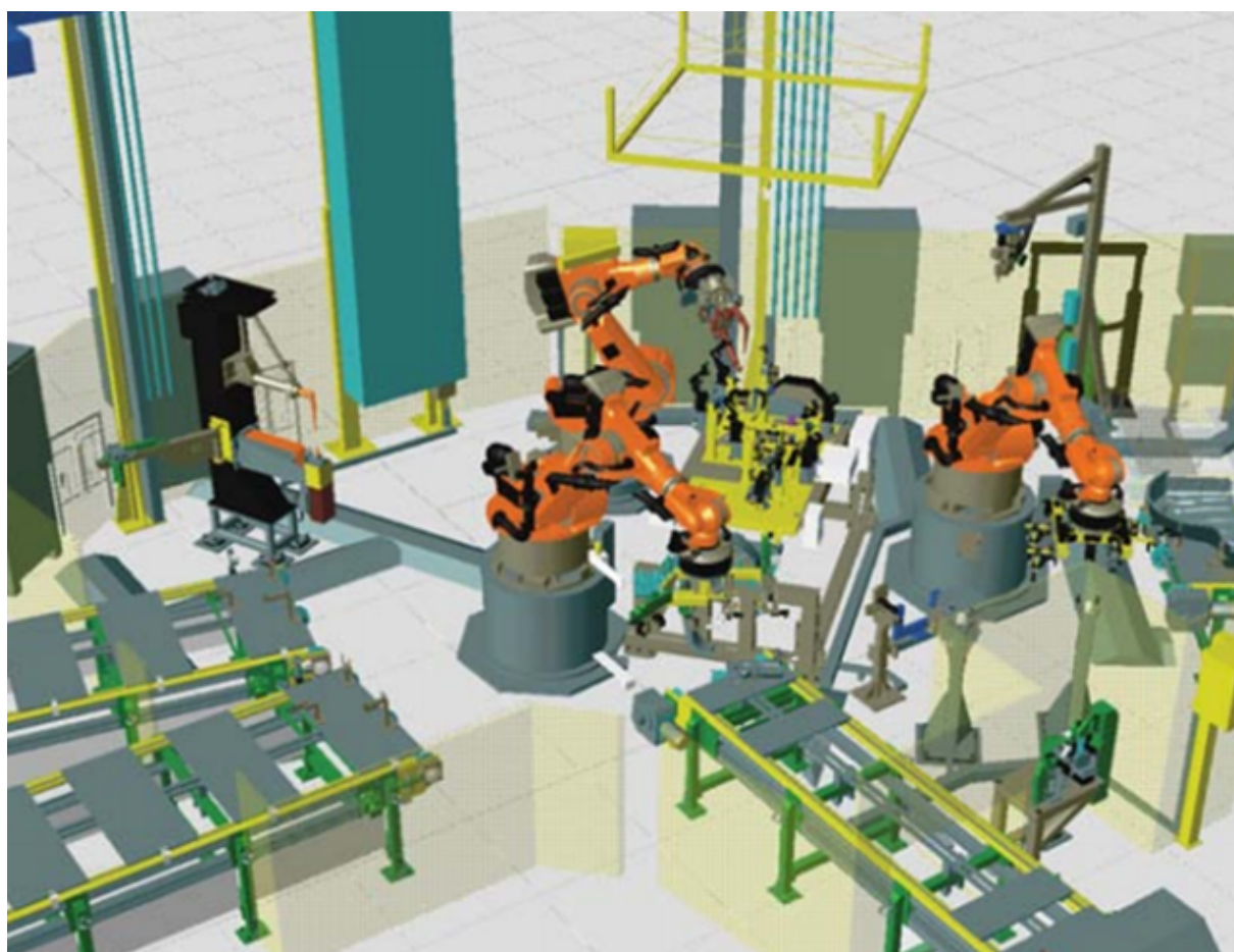
Figura 2.5.1 – Simulação da soldagem a ponto em uma estação de trabalho com o auxílio do software Robocad. Reprodução de (7)
